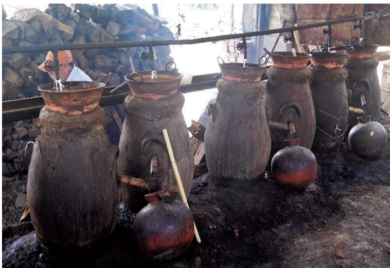
Imagen 3. Alambiques de barro, sistema enfriador y ollas colectoras de mezcal en la comunidad de Abadiano, municipio de Jiquilpan, Michoacán
